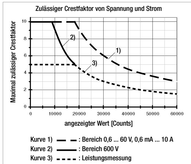
Bild oben: Einfluss des Crestfaktors auf den Anzeigeeumfang
